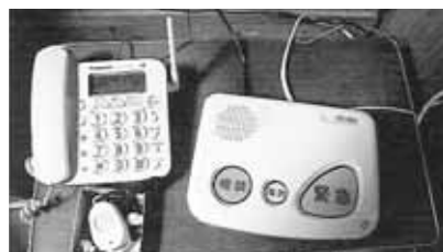
緊急通報装置
