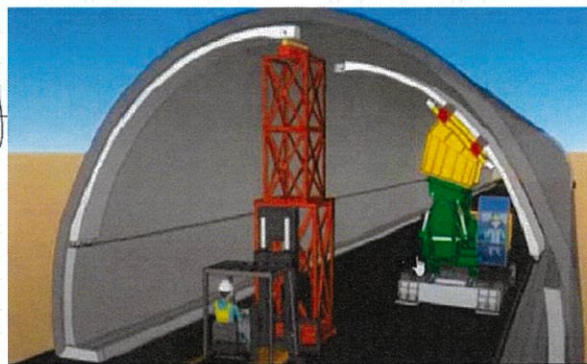
【PCL版のトンネル坑内での組立 イメージ図】
